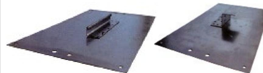
Die Grundplatte ist aus einem 1,5 mm starken Niroblech gefertigt und hat eine Größe von 300 mal 500 mm, damit sie ordentlich eingeflämmt werden kann. Zur Befestigung auf dem Dach sind vier Elf-Millimeter-Löcher gebohrt.
