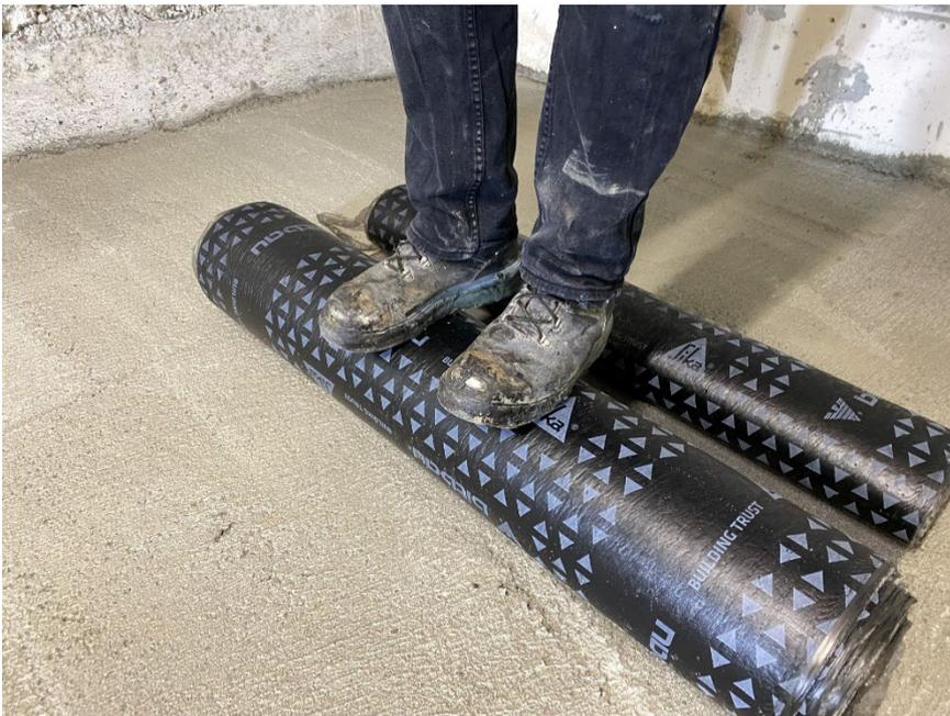
Bitumenbahnen, welche auf gegenständlicher Auf-/ Abrollvorrichtung aufgerollt wurden sind auch unter hoher Punktbelastung verformungsstabil.
