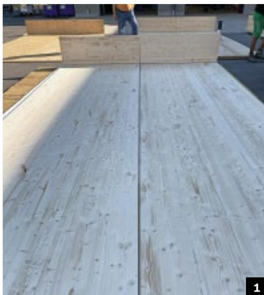
← Modellversuch: Ein aus zwei Hälften bestehendes Holzmodell trennt eine Fuge von rund 10 mm. Unterhalb dieser Fuge befindet sich der Flammenindikator.
