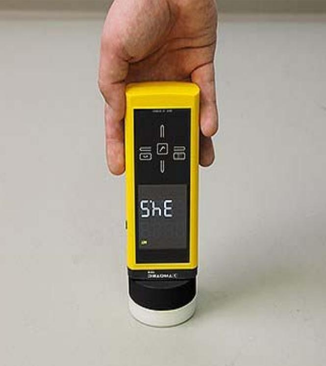
:8 Q rgleip\$ r q ivq err\$ **Auch ein zerstörungsfreies hochfrequentes dielektrisches Messverfahren**
