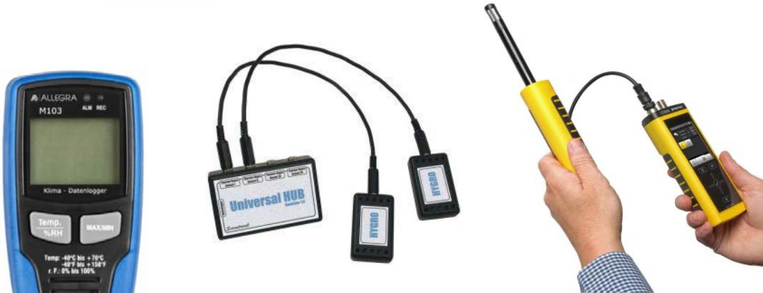
Bei der instationären Messung werden oft Datenlogger zur Langzeituntersuchung verwendet.
