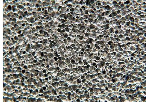
Wasseraufnahmefähigkeit (nach 28 Tagen):  $0,34 \text{ [kg/m}^2] \approx$  pro Quadratmeter Oberfläche
