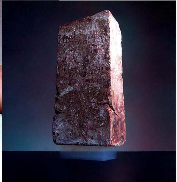
Aerogele sind hochporöse Festkörper dendritischer Struktur, meist auf Silicatbasis mit bis zu 99,98% Luftanteil.
