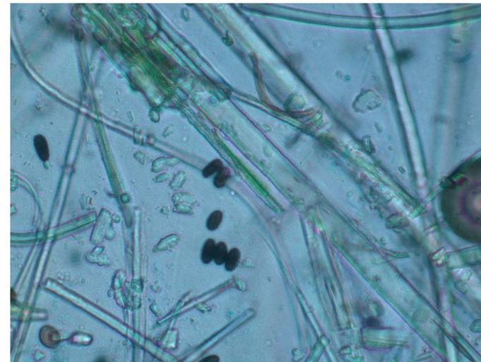
Makroskopisch unauffällige Faserdämmstoff. Im Lupenbild sind Verschmutzungen zu erkennen. Im mikroskopischen Bild sind Sporen von *Stachybotrys chartarum* zu erkennen.
