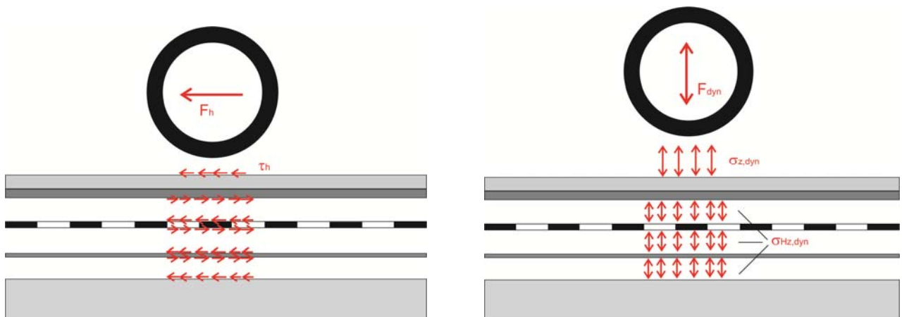
Abbildung 4 und 5: Schub- bzw. Haftzug-Beanspruchungen der einzelnen Schichten
