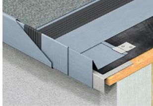
Skizze 36: Dachrand mit dichtender Funktion und Innenentwässerung
