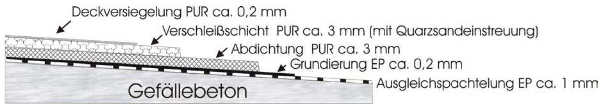
Aufbau eines Parkdecksystems mit einer elastischen PUR- Abdichtung
