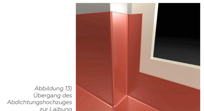
Abbildung 13) Übergang des Abdichtungshochzuges zur Laibung
