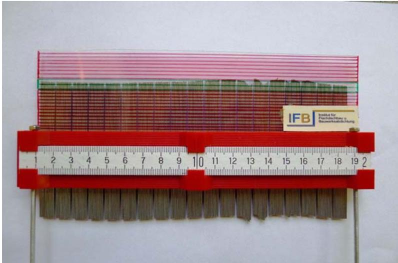
Rein optisch wirkt die Oberfläche schon besonders rau, jedoch keine der Messprüfspitzen befand sich auf der Prüfschablone im roten Bereich.
