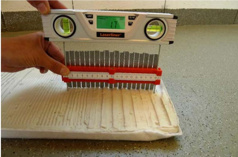
Aufsetzen der Profillehre, gegebenenfalls unter Zusatz einer Wasserwaage.
