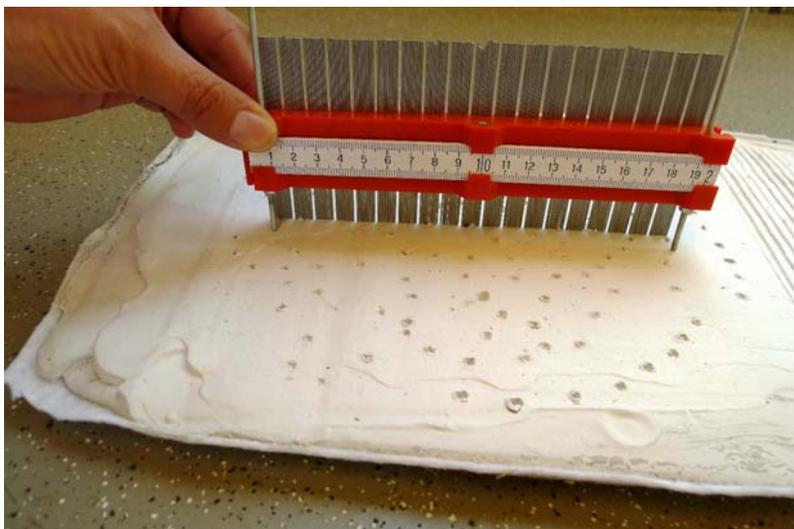
Simulierte punktuelle Vertiefungen in der Oberfläche, Tiefe ca. 2 bis 3 mm.
