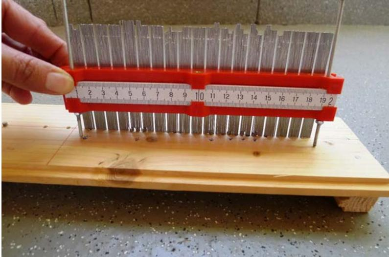
Weiterer Versuch am Holzmodell, wobei die Metallstifte und Bohrungen unterschiedliche Abstände zueinander aufweisen. Die Erhöhung bzw. Vertiefung beträgt jeweils 3 mm.
