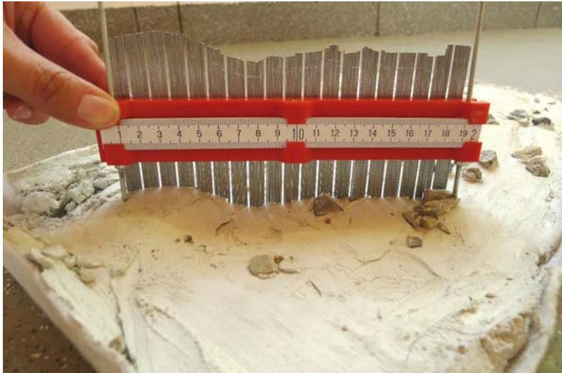
Weitere Prüfung am Gipsmodell mit **extremer** Oberflächenrauheit.
