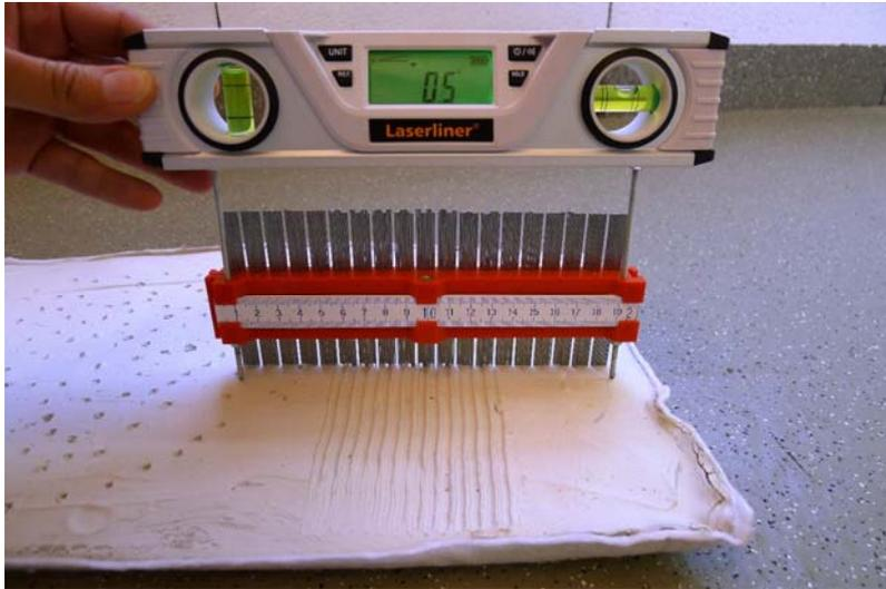
Die Profillehre sollte immer parallel zur Oberfläche geführt werden. Gewährleistet werden kann dies durch z. B. Auflegen einer Wasserwaage.
