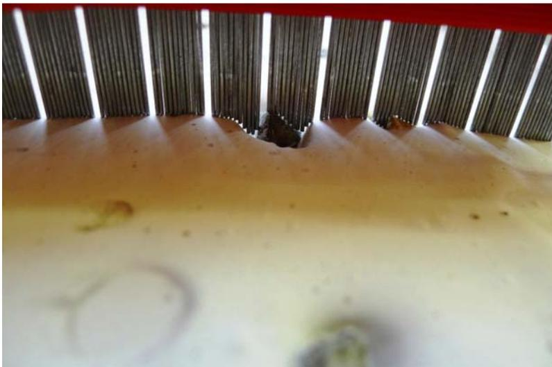
Detailansicht: Baupraktisch wäre diese Situation mit einem Kiesnest in einer Betonoberfläche zu vergleichen.
