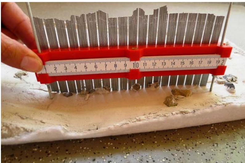
Entspricht einer Oberfläche mit starken Kiesnestern oder Ausbrüchen der Betonoberfläche.
