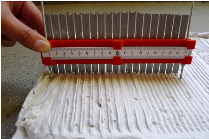
Weiterer Messversuch auf dem Modell mit **erhöhter** Oberflächenrauheit.
