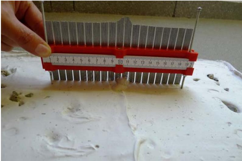
Weiterer Versuch auf dem Gipsmodell mit **sehr hoher** Oberflächenrauheit. Simuliert wird ein Grat oder Rücken in der Betonoberfläche.
