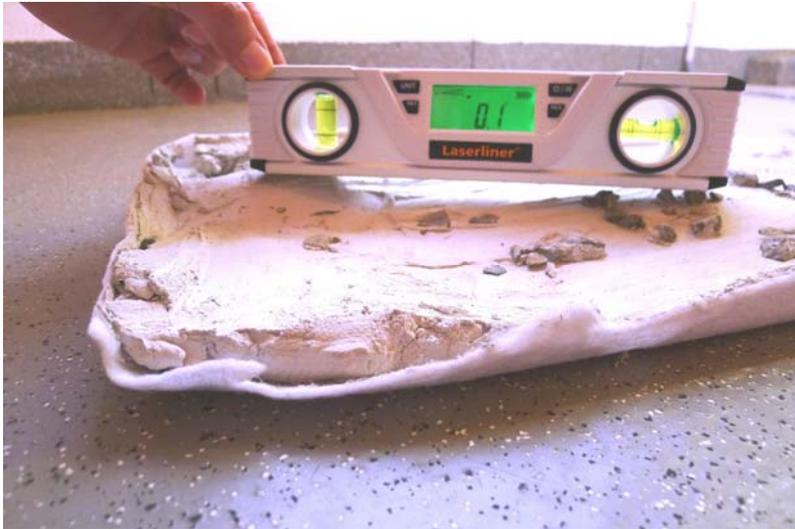
Diese Oberflächengestaltung ist nicht nur problematisch hinsichtlich Oberflächenrauheit sondern auch hinsichtlich den Ebenheitstoleranzen gemäß DIN 18202. Dennoch soll die Auswirkung auf die Oberflächenrauheitsprüfeinrichtung ermittelt werden.
