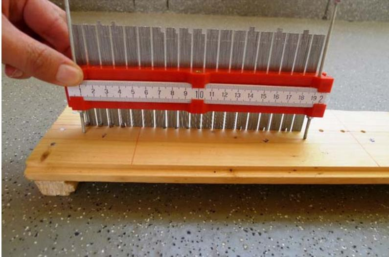
Die Nadeln der Profillehre wurden auf den Erhöhungen und Vertiefungen aufgesetzt und das rote Gehäuse der Profillehre über die Gewindestangen bis zu den Anschlagsscheiben niedergedrückt.
