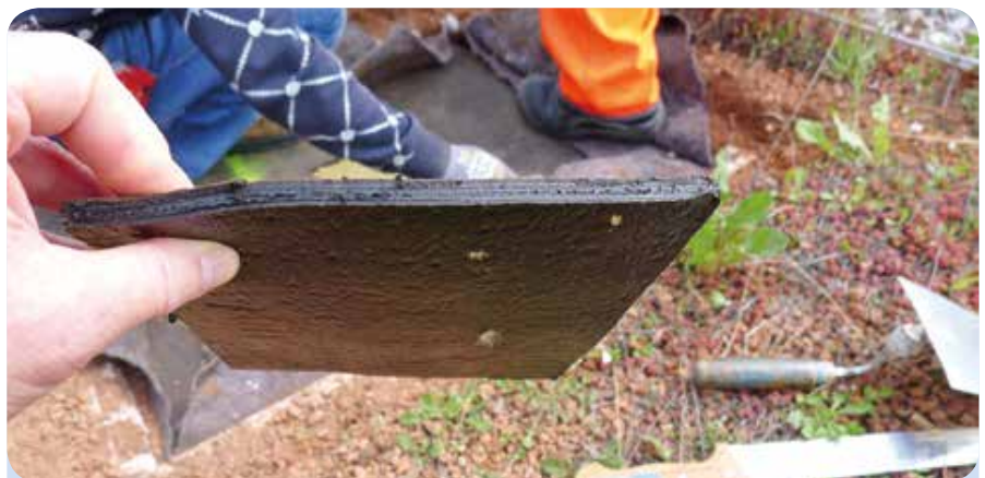
Mehrere Schichten ergeben eine Abdichtungslage.
