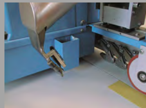
TPO-Dachbahn Nahtfügung mittels Heißluft
