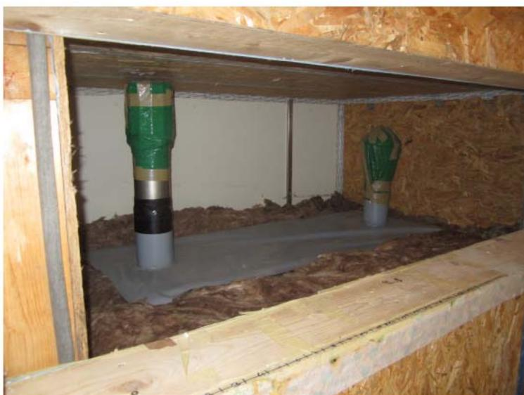
Abbildung 2: Im Differenzklima Prüfstand eingebautes Sanierungsdachelement (1,97 m x 0,81 m) von oben (Kaltseite) mit Zu- und Abluftstutzen sowie abgedämmten Randbereichen.
