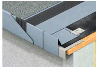
Skizze 36: Dachrand mit dichtender Funktion und Innenentwässerung
